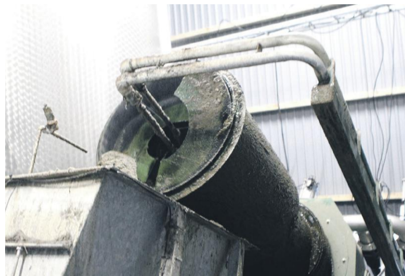
■ Hos I/S Søndergaard er man gået efter den simplest mulige løsning til sandseparering.
